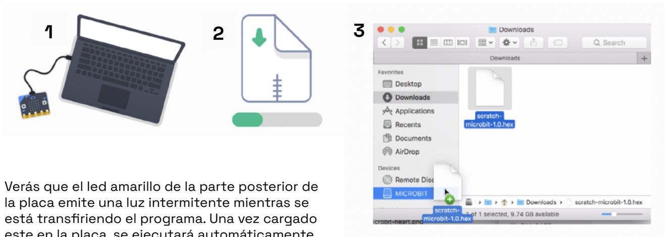
Verás que el led amarillo de la parte posterior de la placa emite una luz intermitente mientras se está transfiriendo el programa. Una vez cargado este en la placa, se ejecutará automáticamente.
