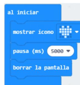
**4** Hasta aquí la primera parte del programa. Ahora, tenemos que hacer que, cuando el robot detecte un objeto con ultrasonido HC-SR04 a 5 centímetros o menos, se pare.
