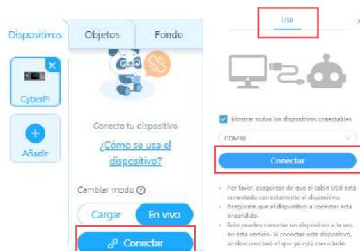
Una vez finalizada la conexión con CyberPi, en el apartado de dispositivos aparecerá la imagen con un círculo azul. El círculo azul indica que la conexión se ha realizado correctamente.
